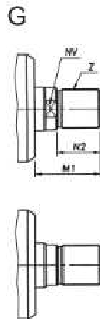
Stempelstangsophæng/Kolbenstangenbefestigung/Piston rod mounting
